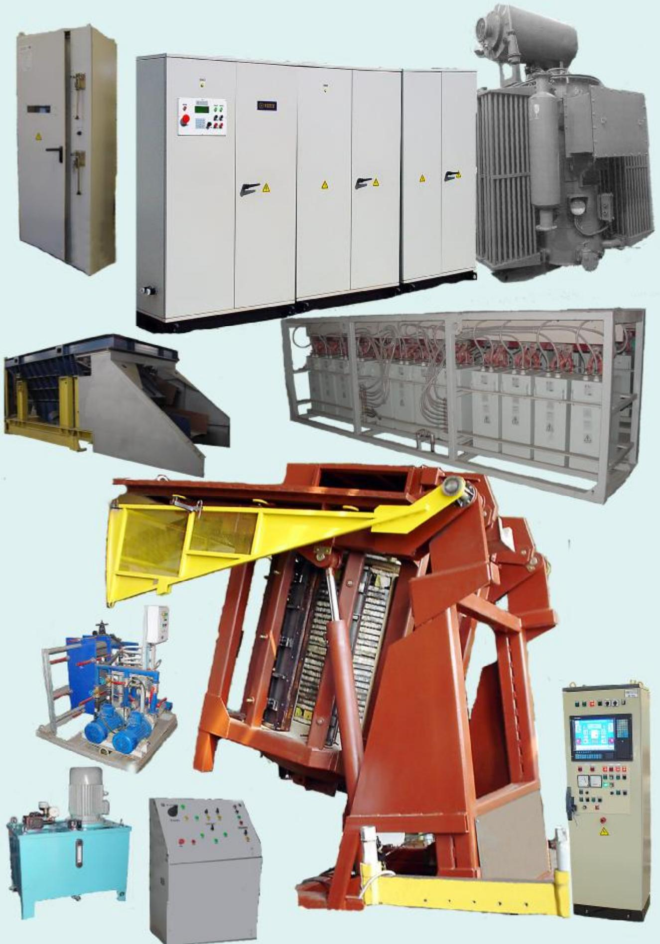
Рис.1. Комплекс оборудования УИПД 3600-0,25-6,0
