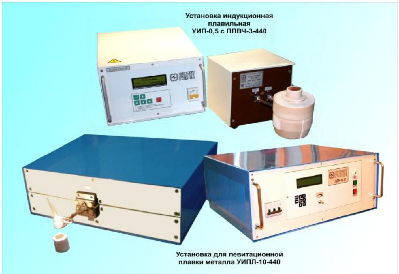
Рис. 7. Индукционные печи малой емкости
