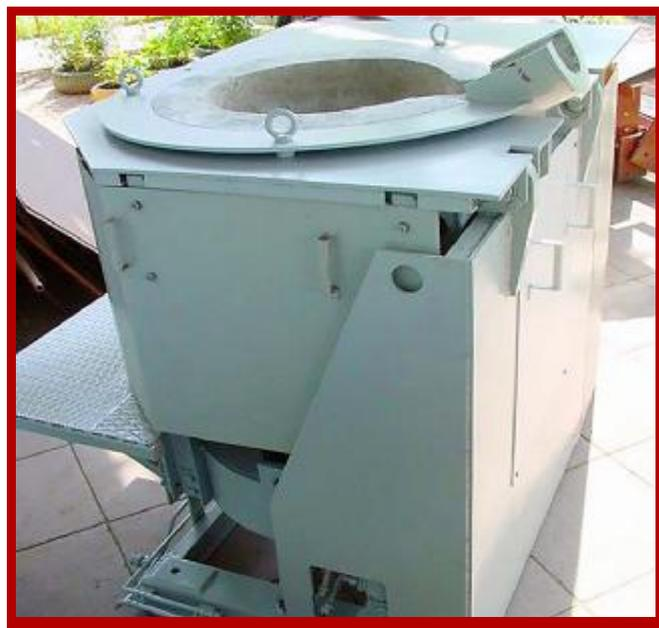
Рис. 8. ИТП с открытой конструкцией
