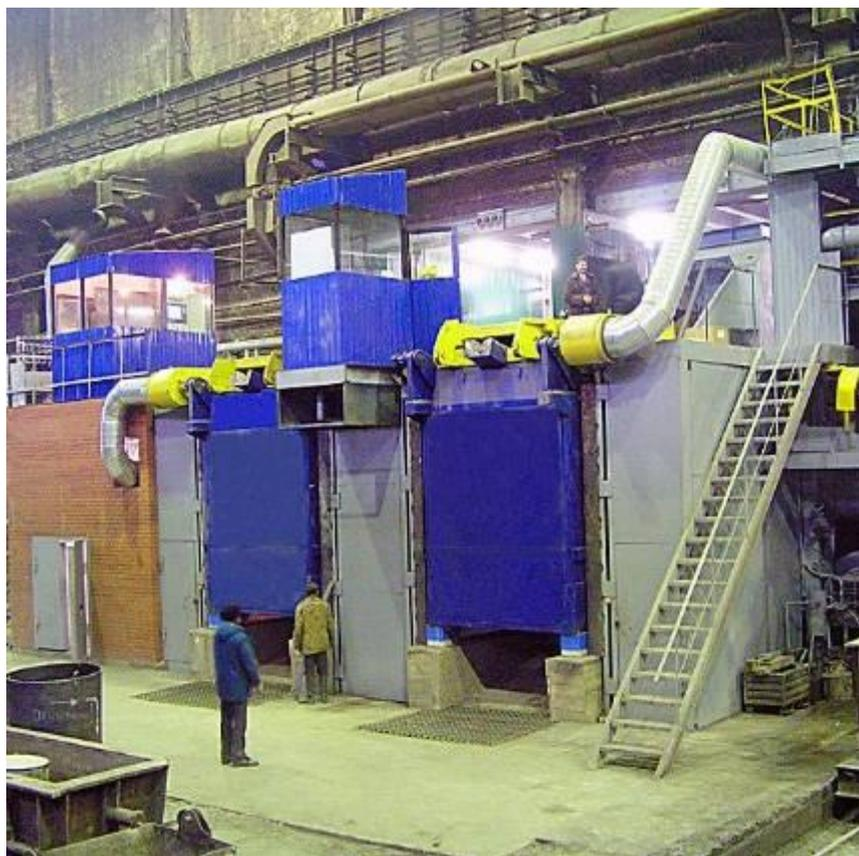
Рис 4. Плавильный участок литейного цеха с двумя печами 6 т
