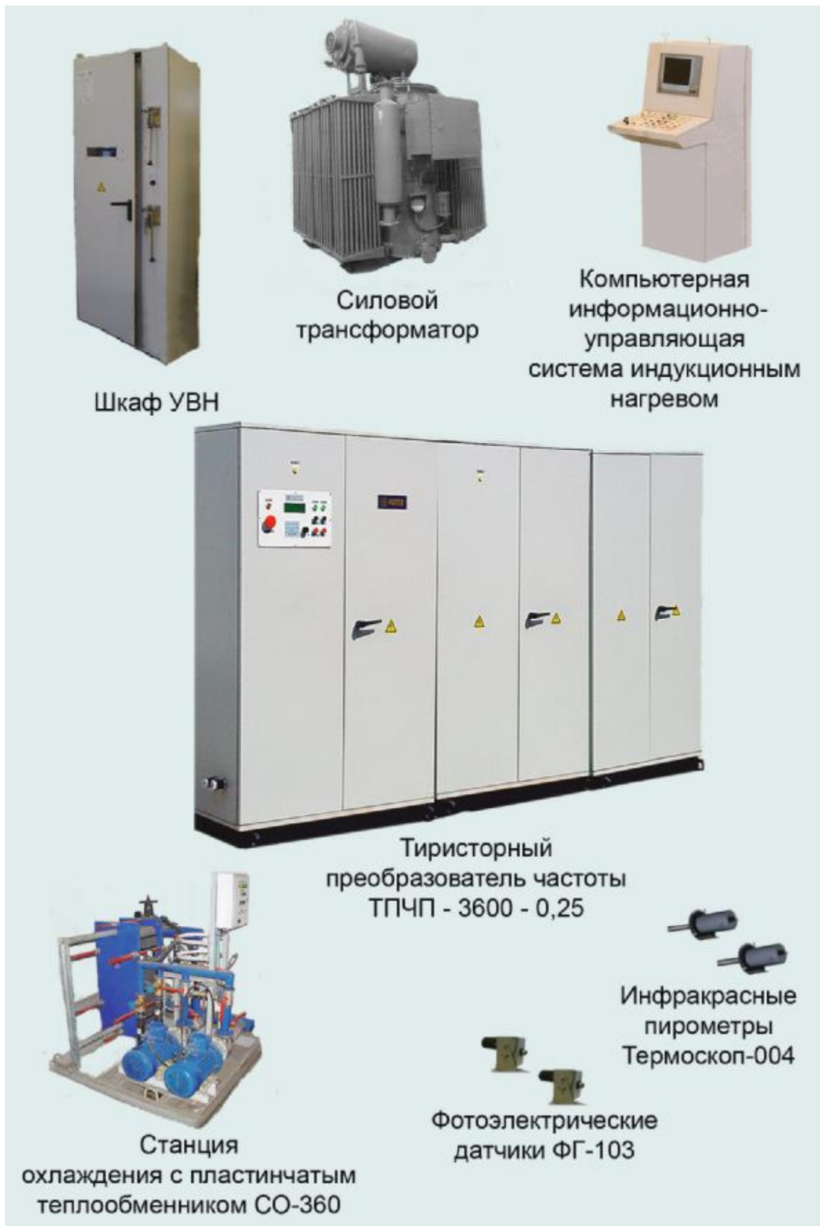
Рисунок 1. Комплекс оборудования системы электропитания среднечастотных установок индукционного нагрева.
