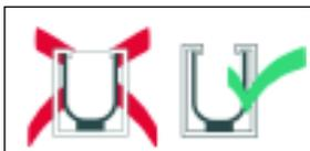
Между стенками/крышкой печи и тиглем должен быть зазор для теплового расширения тигля.
