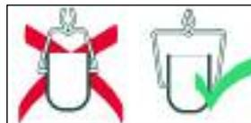
Захват тигля для извлечения/установки должен осуществляться приблизительно на половине высоты тигля
