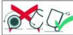
Не катить тигли. Для транспортировки использовать спец. устройства.
