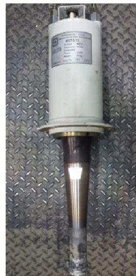
Рис. 1 – Опытная установка, использованная в экспериментах, общий вид прототипа (слева) и детали ультразвукового генератора и волноводного оборудования (справа)
